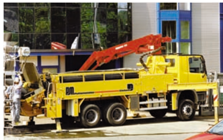
La pluma flexible con plegado en Z alcanza sin ningún problema los lugares de aplicación de difícil accesibilidad.
