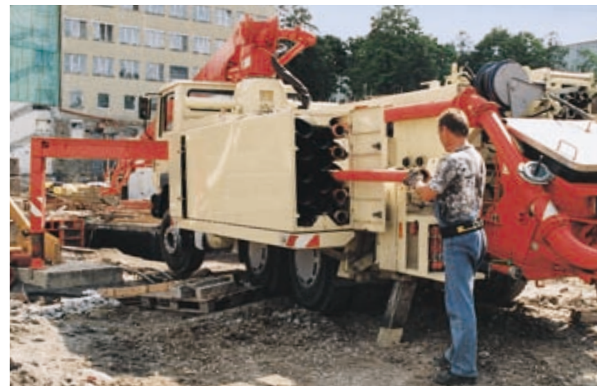
Para un fácil manejo de los tubos y mangueras se dispone de un cajetín de almacenamiento, de descenso hidráulico (opcional, sólo en combinación con una distancia entre ejes de 4200 mm).
