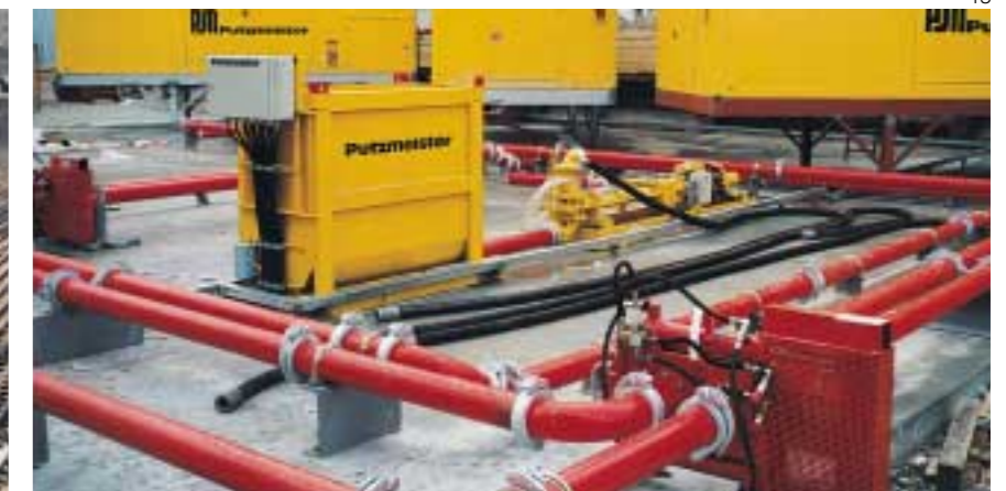
Con las válvulas de corte y de desvío es posible tender con facilidad sistemas de tubería complejos con líneas de suministro PM. En la foto se muestra el sistema de distribución SK en Oresund, Dinamarca.
