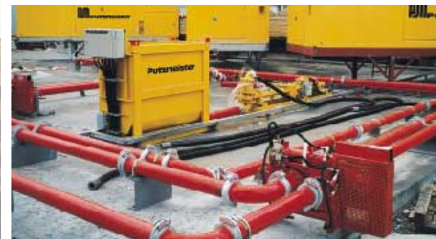
La colocación de sistemas complicados con tuberías PM es fácil por el uso de compuertas y desviación; en la figura, un sistema de distribución SK en Oeresund, Dinamarca.
