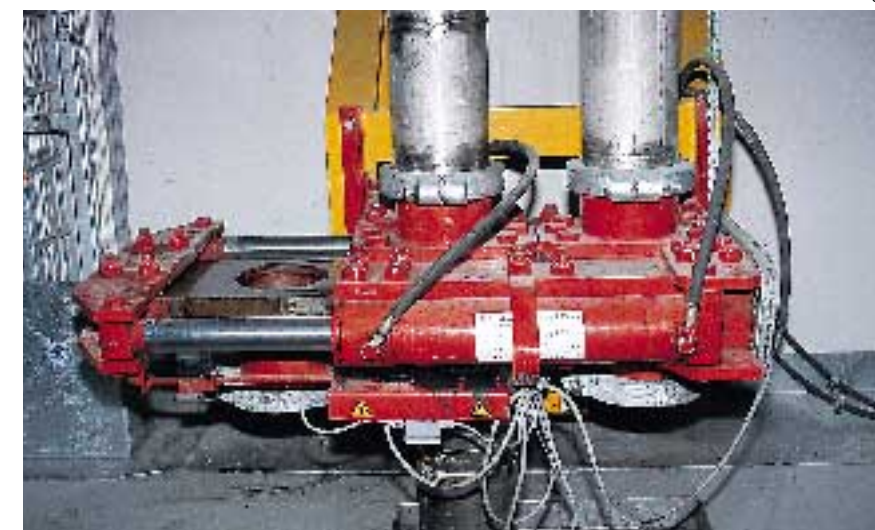
Compuerta de desviación de alta presión DVH 4/2 para la alimentación altern. de 2 tuberías de transporte.
