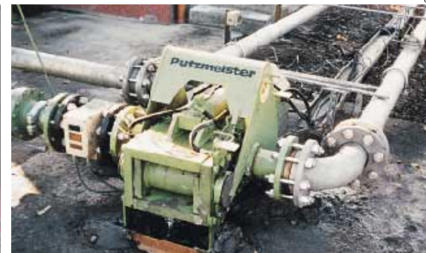
Esclusa de tapones PM para la introducción y extracción de pistones en tuberías de transporte.
