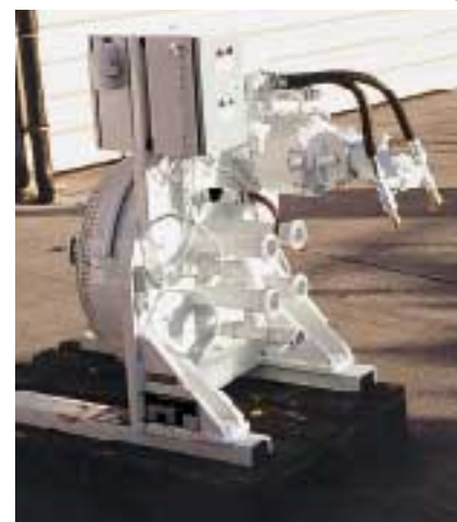
Distribuidor giratorio para la alimentación de varias tuberías de transporte.
