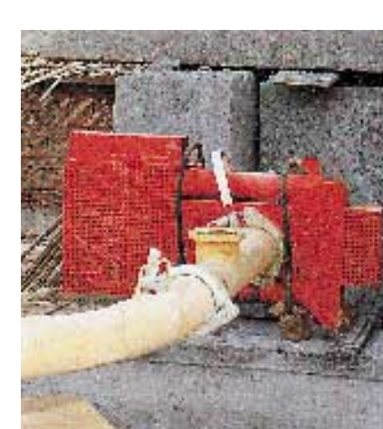
Compuerta de cierre de alta presión GVH 2/2 para cerrar tuberías de transporte.
