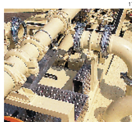
La salida lateral de una autobomba de hormigón con una tubería SK.
